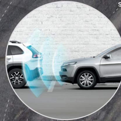
**PARKSENSE<sup>®</sup> FRONT AND REAR PARK ASSIST SYSTEM<sup>5</sup>** ParkView<sup>®</sup> 후방 카메라 시스템과 함께 이 시스템은 차 뒤쪽에 숨겨진 장애물을 미리 확인할 수 있도록 소리와 화면을 통해 경고해줍니다. 후진 중에는 스크린에 거리를 가늠할 수 있는 그리드가 화면에 함께 표시됩니다.
