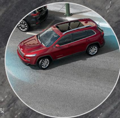
**PARALLEL AND PERPENDICULAR PARK ASSIST<sup>5</sup>** 이 능동형 가이드 시스템은 초음파 센서와 함께 스티어링을 자동으로 조종해 쉽게 차를 주차할 수 있도록 도와줍니다. 앞뒤 ParkSense<sup>®</sup> 주차보조 시스템 센서가 포함되어 있습니다. (Longitude High 및 Limited 모델 적용)
